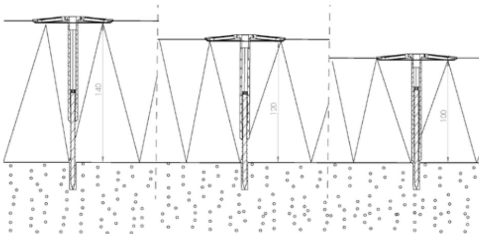
На изображении в качестве примера: крепеж 100 мм отрегулирован так, чтобы соответствовать толщине теплоизоляционного слоя в 100, 120 и 140 мм.
